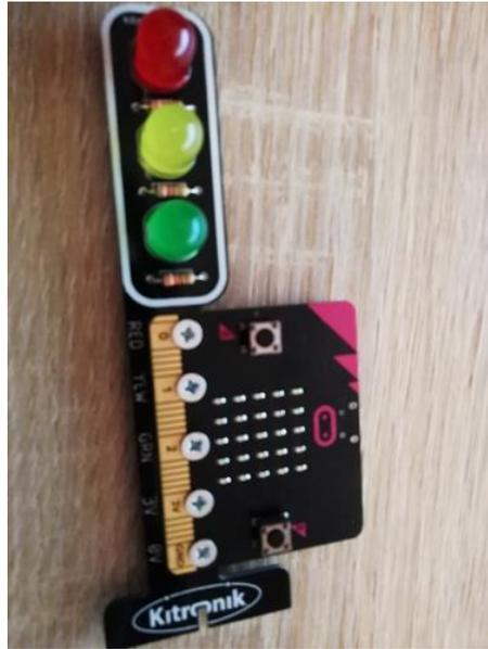
Le micro:bit connecté au feu tricolore est aussi connecté à un bloc d'alimentation.
